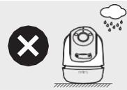
A câmera não é à prova d'água quando colocada sobre uma mesa ou prateleira. Monte a câmera através da Opção 1 ou Opção 2 ao instalar ao ar livre.
